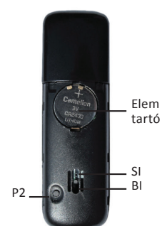
Hátoldal nyitott fedélnél P2: programgomb SI/BI: Egy-irányú kommunikáció / Két-irányú kommunikáció kapcsoló (Bírdirekcionális rádió)
