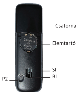
Hátoldal nyitott fedélnél: P2 programgomb SI/BI: Egy-irányú kommunikáció / két-irányú kommunikáció kapcsoló (Bidirekcionális rádió)
