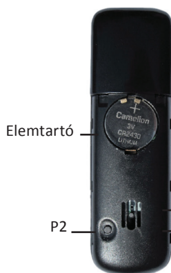
Hátoldal nyitott fedélnél: P2 programgomb SI/BI: Egy-irányú kommunikáció / két-irányú kommunikáció kapcsoló (Bidirekcionális rádió)
